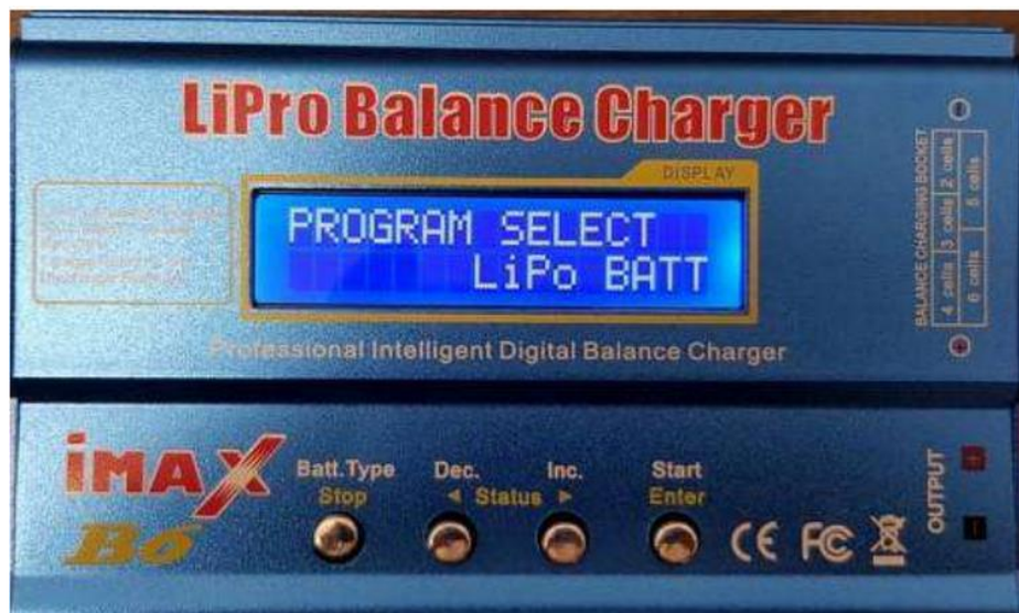
Figure 2 : Sélection du programme sur le module de charge batteries
