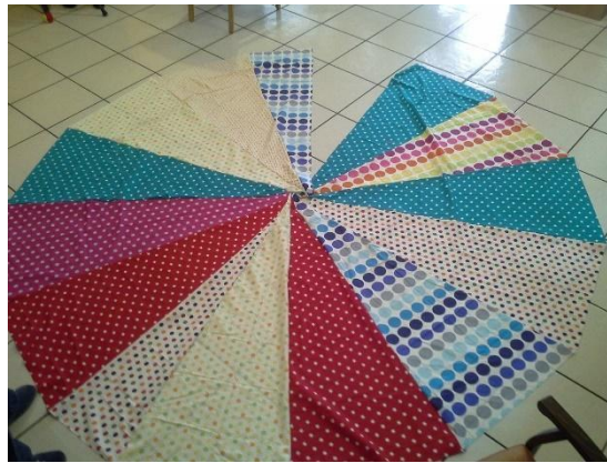
Figure 10 : Illustration pour la couture du parachute circulaire
