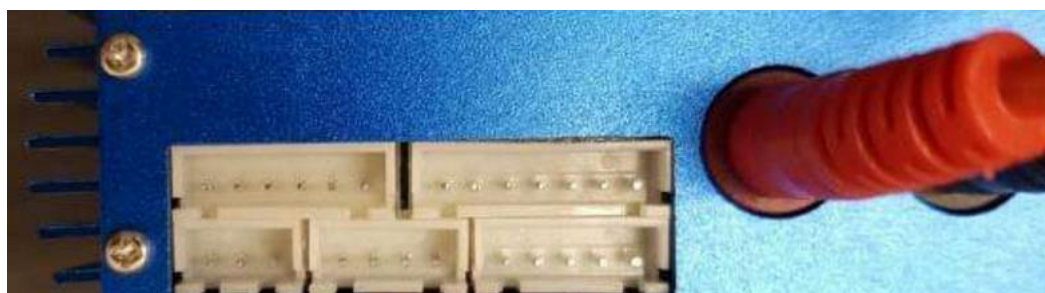
Figure 3 : Connecteur d'équilibrage (à gauche) et prise DEAN (à droite)
